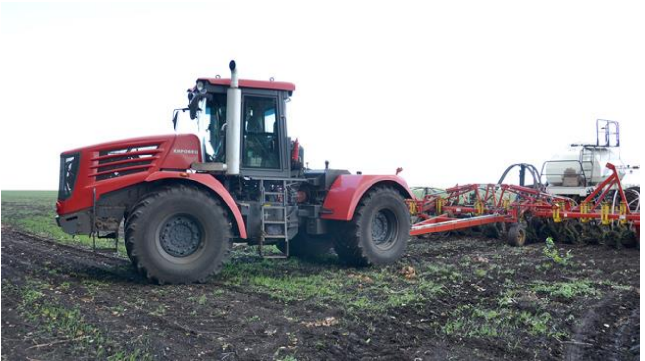
Второй КИРОВЕЦ К-744Р4-ПРЕМИУМ 2016 года выпуска работает с канадским 12-метровым комплексом «Борго» в составе сеялки 8810-35 и бункера модели 6350.
