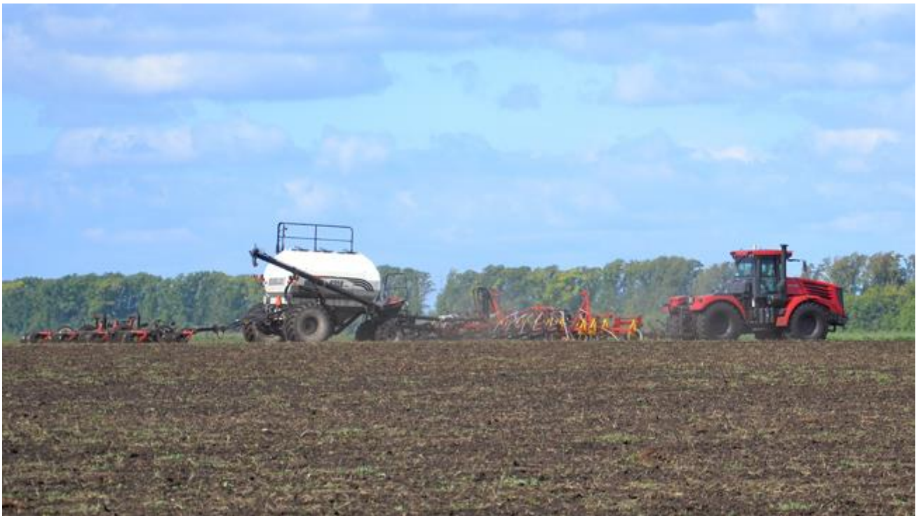
Здесь бункер идет позади сеялки, поэтому за ним ставят дополнительные разравнивающие катки.
